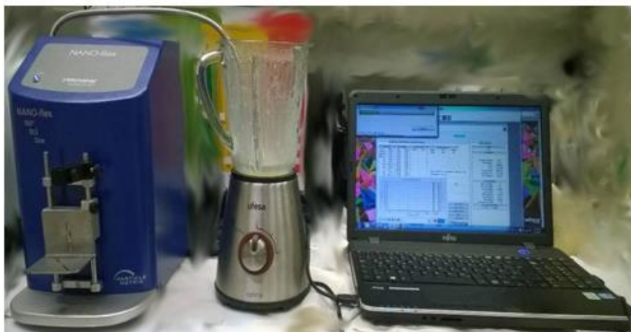
Figura 3.2 - Montagem experimental da emulsificação do ASA, utilizando o aparelho NANO-flex DLS Microtrac e o software Microtrac FLEX versão 11.0.0.2.
